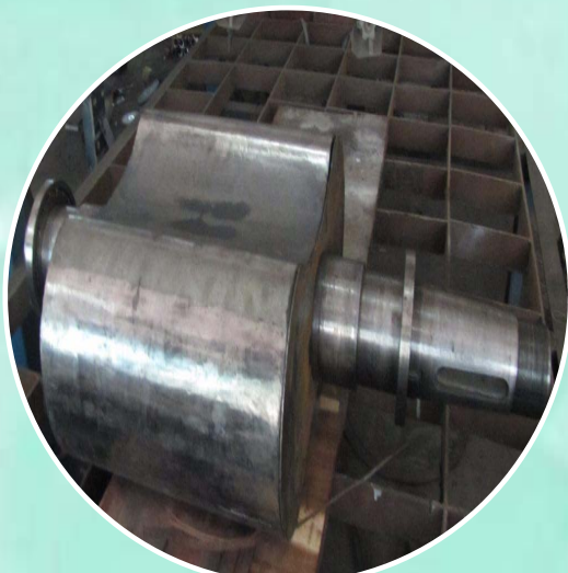
3. Phục hồi và phun phủ các quạt hút chân không của hệ thống vận chuyển tro bay - UB330MW
