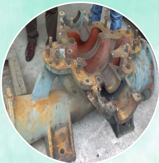
3. Phục hồi và phun phủ các quạt hút chân không của hệ thống vận chuyển tro bay - UB330MW
